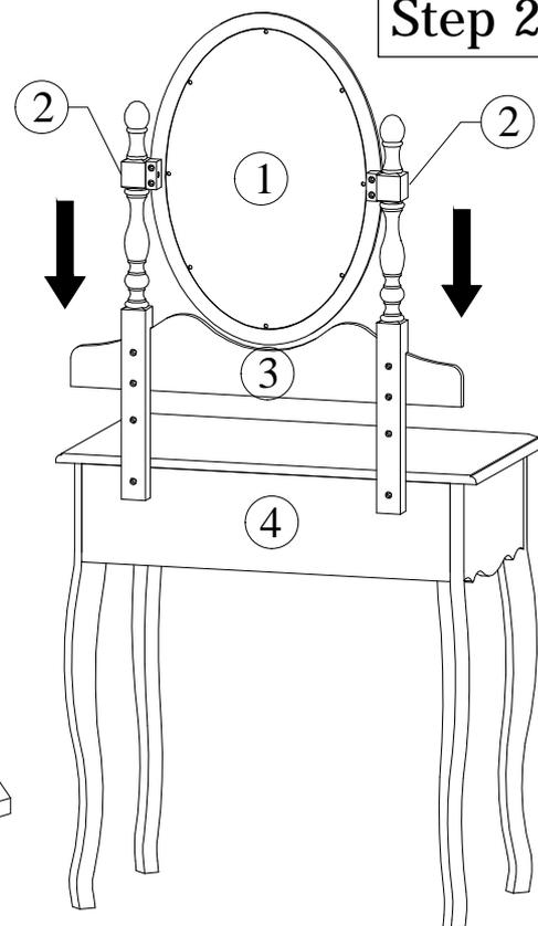
1. Pasang Penyangga Cermin pada Cermin, kaitkan menggunakan baut Jcbc M6 x 70, Ring besi, & Mur. Masukkan baut pada lubang yang tersedia, putar kearah kanan searah jarum jam hingga baut terpasang rapat memakai kunci L, Tahan mur memakai kunci pas. Agar mur tidak ikut berputar.
