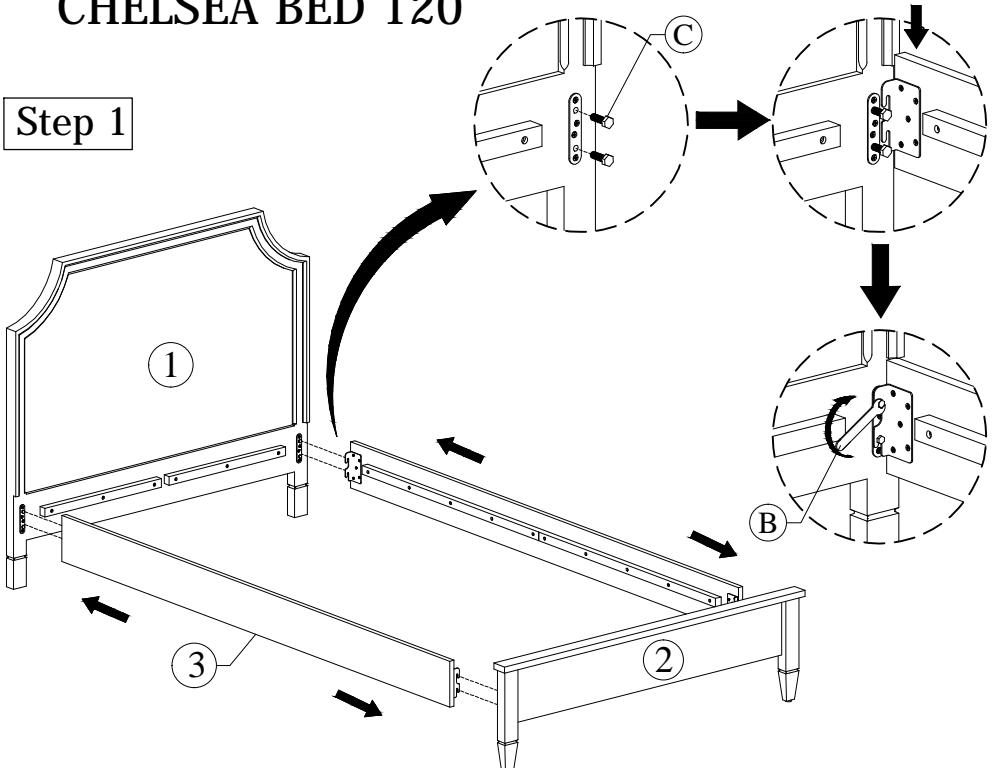
1a. Pasang baut hexagon M8 x 15mm pada Plat besi yang terpasang pada Headboard dan Footboard,
