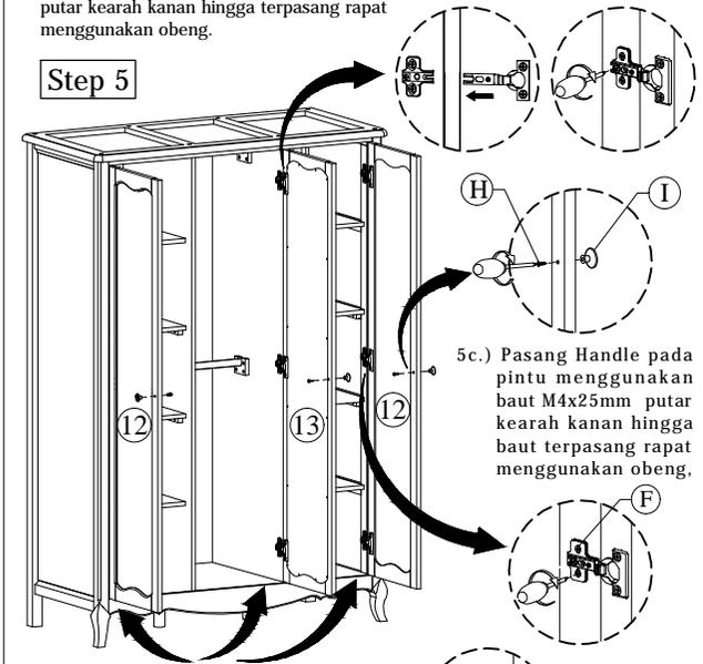
5c.) Pasang Handle pada pintu menggunakan baut M4x25mm putar kearah kanan hingga baut terpasang rapat menggunakan obeng.
