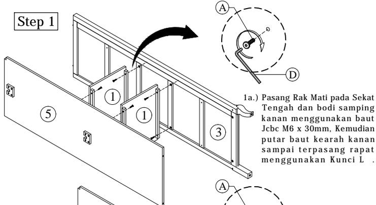
1a.) Pasang Rak Mati pada Sekat Tengah dan bodi samping kanan menggunakan baut Jcbc M6 x 30mm, Kemudian putar baut kearah kanan sampai terpasang rapat menggunakan Kunci L .
