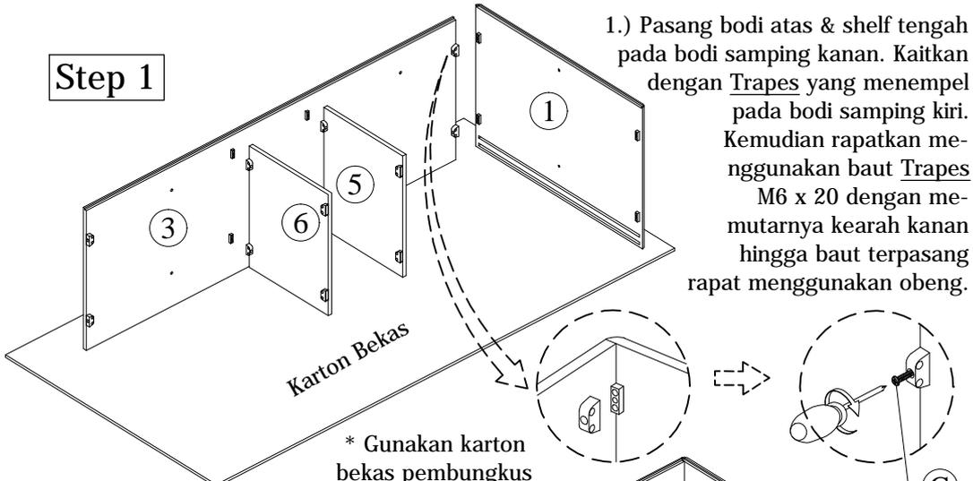
1.) Pasang bodi atas & shelf tengah pada bodi samping kanan. Kaitkan dengan Trapes yang menempel pada bodi samping kiri. Kemudian rapatkan menggunakan baut Trapes M6 x 20 dengan memutarkannya kearah kanan hingga baut terpasang rapat menggunakan obeng.
