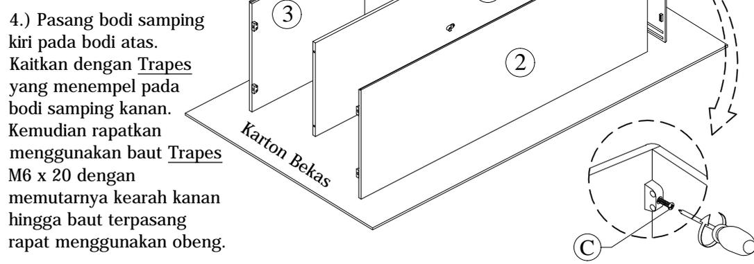
4.) Pasang bodi samping kiri pada bodi atas. Kaitkan dengan Trapes yang menempel pada bodi samping kanan. Kemudian rapatkan menggunakan baut Trapes M6 x 20 dengan memutarkannya kearah kanan hingga baut terpasang rapat menggunakan obeng.
