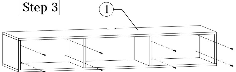
3. Pasang Bodi pada dinding menggunakan sekrup 8 x 2" pada lubang yang telah dipasang Fisher memakai Obeng, Putar kearah kanan searah jarum jam hingga sekrup terpasang rapat.
